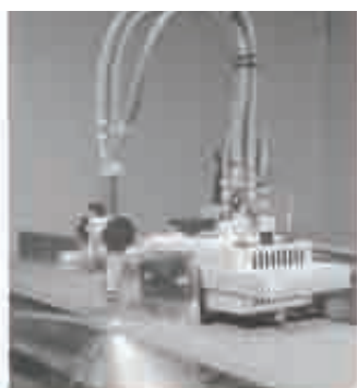
ProFIT для выполнения автоматических прямых резов благодаря подаче с угловым профилем
