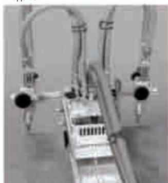
ProFIT с резаками, расположенными с двух сторон и для выполнения полосовых резов
